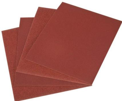
Prodotto universale di eccellente qualità, si può sezionare con molta facilità, ottima adattabilità al pezzo da lavorare, grazie al supporto in cotone molto flessibile. Utilizzabile su acciai, metalli, metalli non ferrosi, legno e acciaio inox. Legante in resina, abrasivo in ossido di alluminio.
