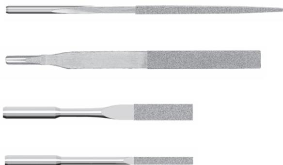
Lime diamantate che possono essere impiegate su macchine limatrici. Le ridotte dimensioni e le diverse forme geometriche sono espressamente realizzate per lavorare con le limatrici alternative. Utilizzabili su carburo di tungsteno, acciaio temperato e nitrurato, stellite, ceramiche, ferrite, vetro, pietre dure e preziose, quarzi, fibre di carbonio. Grana D151 per sgrossatura. Utili per impieghi universali.
