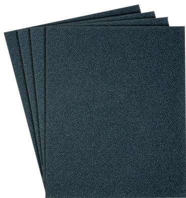
Prodotto speciale per carrozzerie. Ideale per superfici dure e resistenti. Impiegabile su pittura, vernice, stucco e plastica. Eccellente adattabilità al pezzo da lavorare e mantenimento di un alto grado di stabilità e di resistenza. Può essere utilizzato per la smerigliatura a secco e a umido. Legante in resina, abrasivo carburo di silicio, supporto A-carta.
