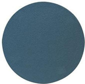
Dischi in tela abrasivi allo zirconio velcrati sono di qualità superiore e vengono utilizzati per la lavorazione di metalli non ferrosi, acciai duri e speciali cordoni di saldatura, spigoli ecc. Il velcro rende rapido il cambio dell'utensile. I contorni del disco si adattano perfettamente grazie alla loro elevata flessibilità. La velocità periferica massima consentita è di 32 m/sec. La finitura è graduale in base alla grana scelta.
