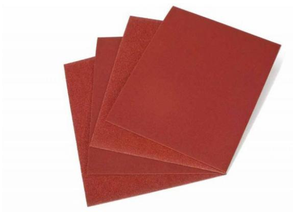
Utilizzabile per lavorazioni manuali di metalli ferrosi e non ferrosi, particolarmente efficace su stampi, armi e pentole. Utilizzabili a secco. Supporto in tessuto di cotone molto flessibile tipo F con legante doppio strato di resina.
