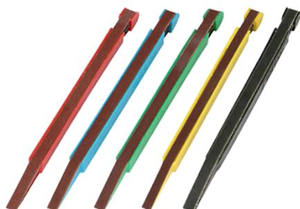
"Belt Stick" è un piccolo attrezzo da usare a mano. È adatto per smussare e lisciare superfici di difficile accesso. Il sostegno di polipropilene è robusto ed il nastro è tenuto in tensione per mezzo di una molla che facilita anche la sostituzione del nastro. Il nastro di tela all'ossido d'alluminio legato a resina può essere ruotato di 360° e perciò usato per tutta la lunghezza.
