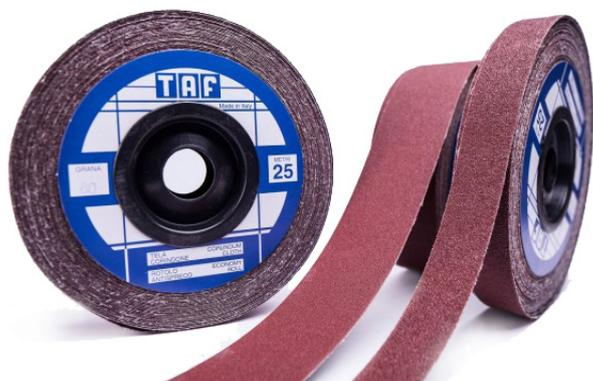
Utilizzabile per lavorazioni manuali di metalli ferrosi e non ferrosi, particolarmente efficace su stampi, armi e pentole. Utilizzare a secco. Supporto in tessuto di cotone molto flessibile tipo F con legante doppio strato di resina.
