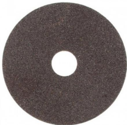
Disco da taglio a legante resinoide adatto per troncatura di particolari in acciaio e acciaio super-rapido. Disco troncatore ad alto rendimento non rinforzato per macchine stazionarie e per affilatrici di seghe automatiche. Disco adatto unicamente alla troncatura ad umido su macchine stazionarie, in quanto prodotte senza rinforzo. Il pezzo da lavorare dev'essere ben fissato durante la lavorazione ed il disco non deve essere esposto a carico laterale.
