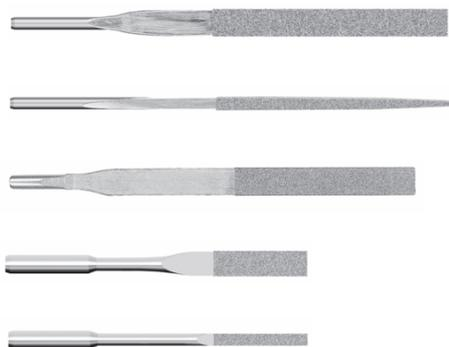
Lime diamantate che possono essere impiegate su macchine limatrici. Le ridotte dimensioni sono espressamente realizzate per lavorare con limatrici alternative. Utilizzabili su carburo di tungsteno, acciaio temperato e nitrurato, stellite, ceramiche, ferrite, vetro, pietre dure e preziose, quarzi, fibre di carbonio. Grana D107 per media finitura.
