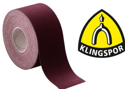
Prodotto universale di eccellente qualità, si può sezionare con molta facilità, ottima adattabilità al pezzo da lavorare, grazie al supporto in cotone molto flessibile. Utilizzabile su acciai, metalli, metalli non ferrosi, legno e acciaio inox. Legante in resina, abrasivo in ossido di alluminio.
