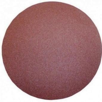
I dischi in tela abrasivi al corindone velcrati sono di utilizzo universale. Il velcro rende rapido il cambio dell'utensile. I contorni del disco si adattano perfettamente grazie alla loro elevata flessibilità. La velocità periferica massima consentita è di 32 m/sec. La finitura è graduale in base alla grana scelta.
