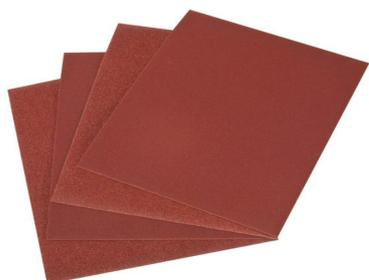
Prodotto universale di eccellente qualità, si può sezionare con molta facilità, ottima adattabilità al pezzo da lavorare, grazie al supporto in cotone molto flessibile. Utilizzabile su Acciai, metalli, metalli non ferrosi, legno e acciaio inox. Biadesivo telato, legante in resina, abrasivo in ossido di alluminio.
