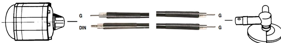
Alberi flessibili, composti da un'anima metallica completa di attacchi e da una guaina di protezione in gomma con rinforzi terminali e gli attacchi per le macchine e le impugnature.
