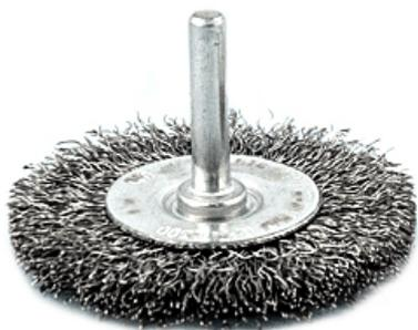
Spazzole a disco di costruzione robusta, con gambo e filo in acciaio. Utilizzate per la pulizia di ruggine, vernice o altro e per la sbavatura leggera su piccole aree con macchine portatili.
