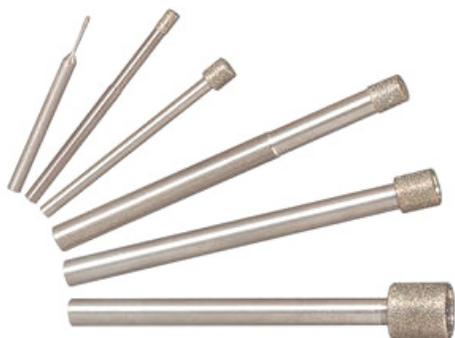
Utensili diamantati in CBN. Utensili con legante resinoidi che vengono impiegati per lavorare utensili in metallo duro o acciaio super-rapido, ma anche in altri processi produttivi, sia nella smerigliatura a secco che quella a umido. La forma cilindrica è adatta a lavorazioni interne, come fori, raggiate e profili in uso manuale e stazionario.
